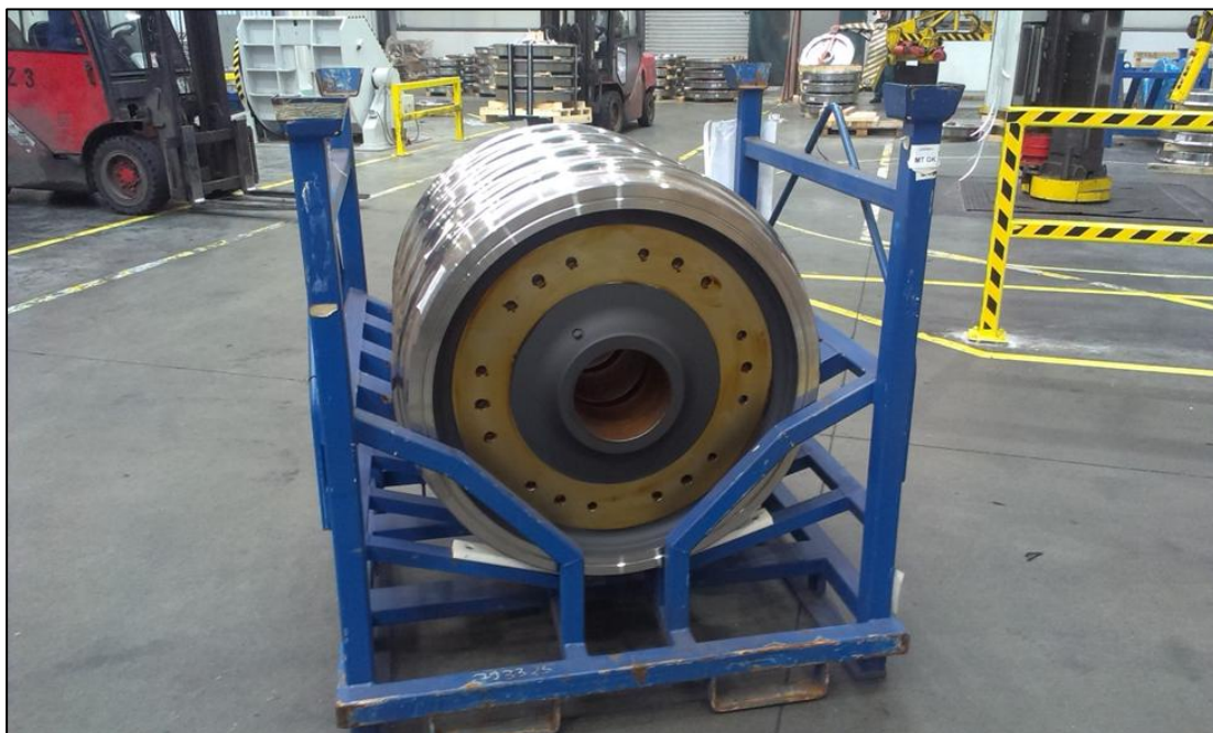
Slika 1. Slika prikazuje enega izmed načinov pakiranja monoblok koles v kovinsko embalažo, ki omogoča skladiščenje le-teh v več nivojih!
