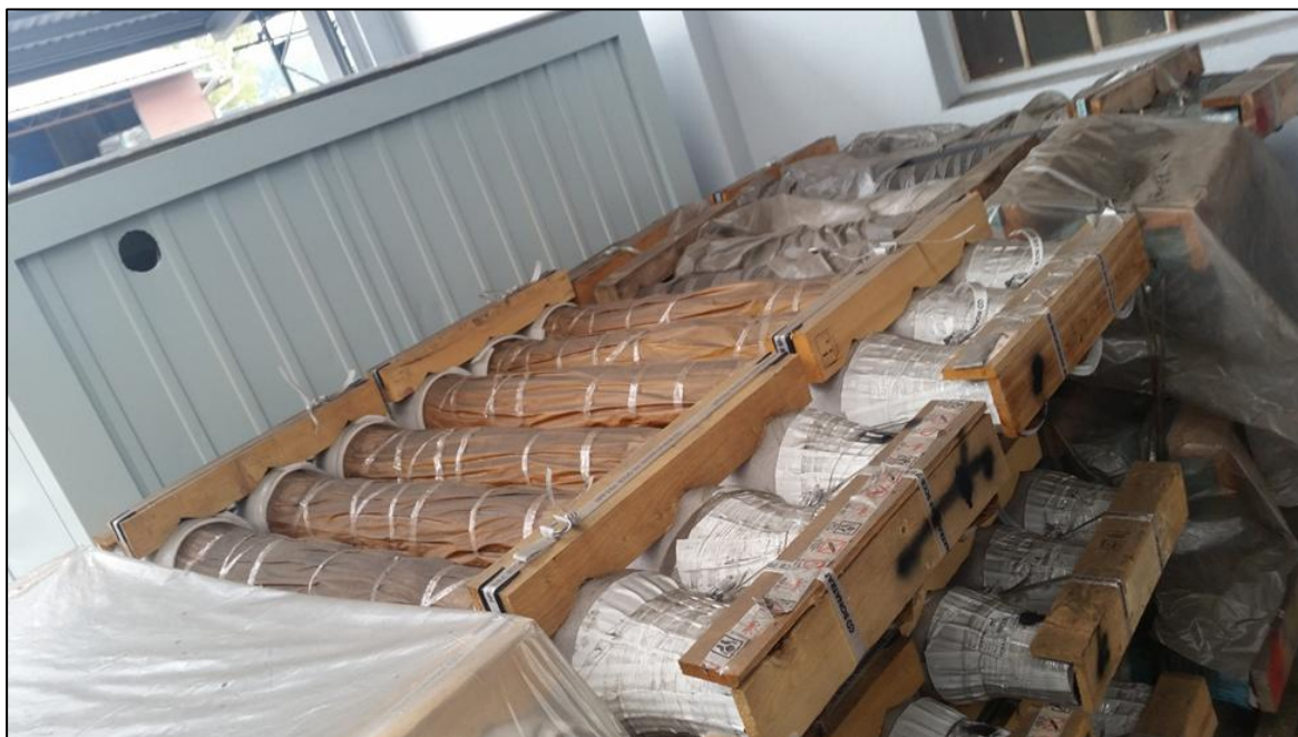
Slika 2. Eden izmed načinov pakiranja osi, ki omogoča skladiščenje le-teh v več nivojih!
